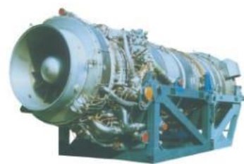
НК-16СТ, изготавливаемый заводом с 1982 года для магистральных газопроводов, по своим технико-эксплуатационным характеристикам не уступал зарубежным аналогам, а в чем-то даже превосходил их.
